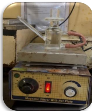
Figure 12. Franz Diffusion Apparatus
